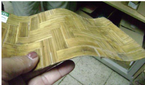
Figura 28. Tablero ondulado o corrugado
