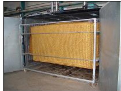
Escurrido de la resina de las esteras
