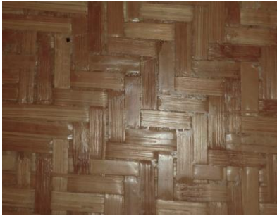
Prototipo de tablero tejido impregnado con UPF, ICIDCA-Mederico, 2012
