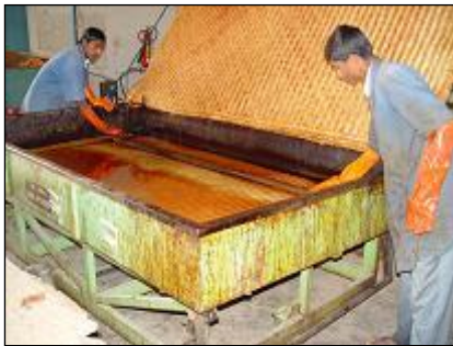
Aplicación de la resina a las esteras
