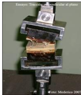
Ensayo de tracción perpendicular
